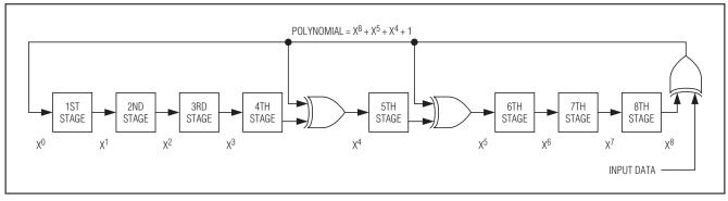
图3. 1-Wire CRC发生器
