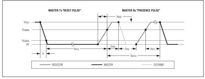
图6. 初始化流程:复位和在线应答脉冲
