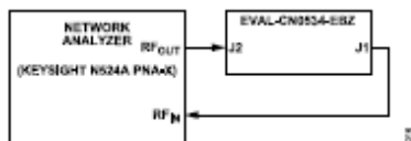
图 17. S 参数和噪声系数测试设置框图
