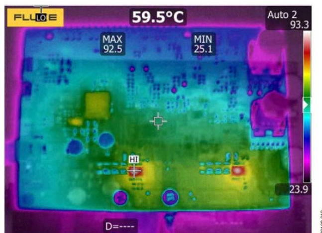
图 11. EVAL-CN0508-RP1Z 在 30 V 输入、向 4 Ω 负载提供 2.75 A 限流输出时的热图像
