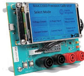
图2. MAXREFDES183# 精密校准器
