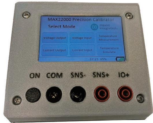
图 7. MAX22000 精密校准器的 3D 打印外壳
