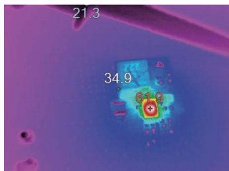
图7. 3 mm  $\times$  4 mm LT8636在13.5 V至5 V/4 A恒定负载加4 A脉冲负载（10%占空比）下的热图显示温度上升。
