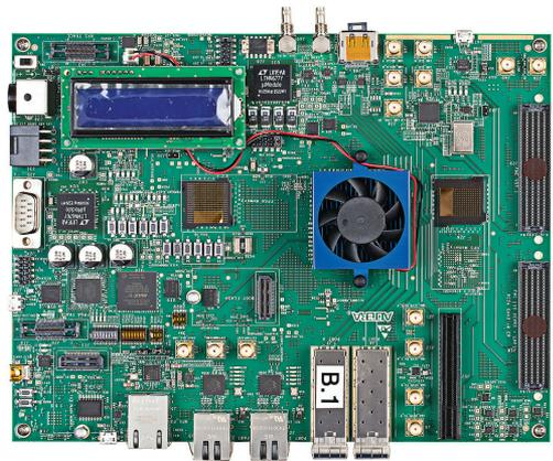
图16. Altera Arria 10 SoC开发套件。
