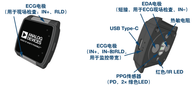
图2. VSM手表 (集成多款ADI器件, 旨在凸显超低功耗、小尺寸轻型产品)。
