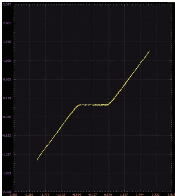
图 4. 电压传输曲线
