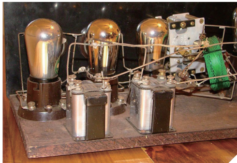
图A. 早期使用木制试验板技术构建的无线电接收器。需要注意的是，真空管板电压可以高达300 V dc，因此在施加电源后必须小心谨慎。
