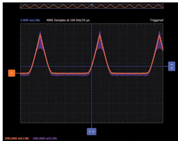
图5. Scopy绘图中的电流镜波形，W2为10 kHz频率。
