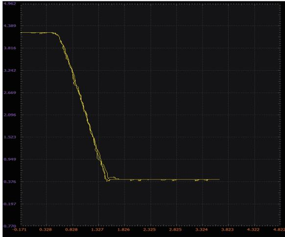
图7. TTL逆变器传输曲线
