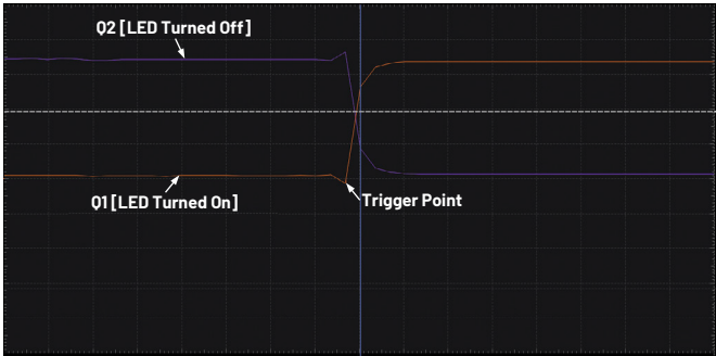
图7. 触发时的单稳态多谐振荡器行为
