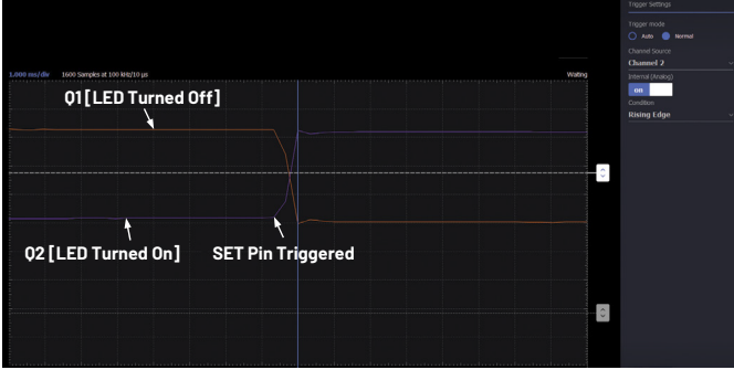
图10. 触发SET引脚的双稳态多谐振荡器行为
