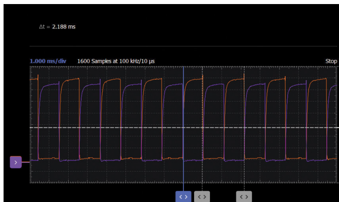
图4. 使用0.1 \mu F电容时的非稳态多谐振荡器间隔
