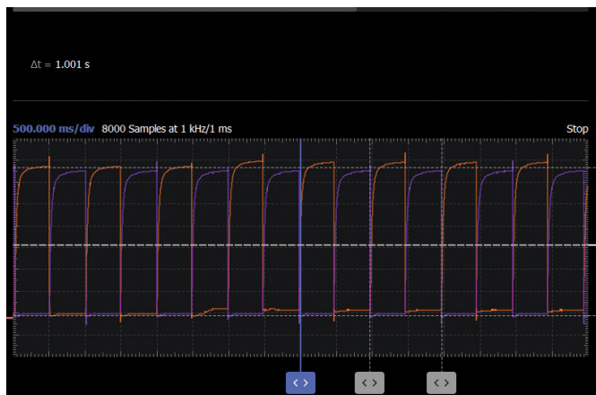
图3. 使用47 \mu F电容时的非稳态多谐振荡器间隔
