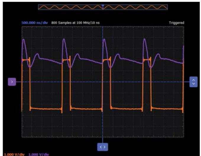
图5. 通道2测量发射极电阻 $R3$ 两端的电压。
