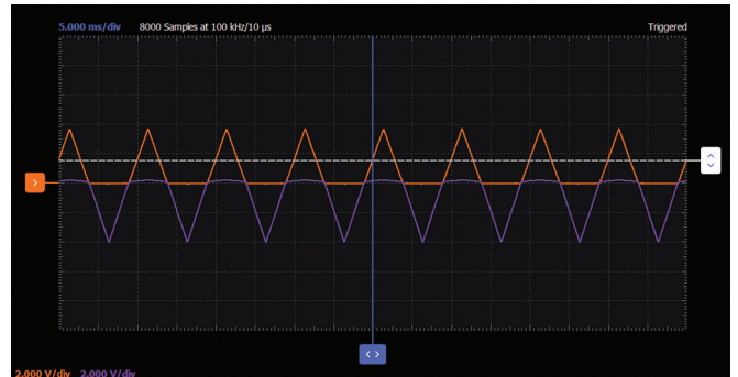
图10. 降低二极管有效正向压降的波形。
