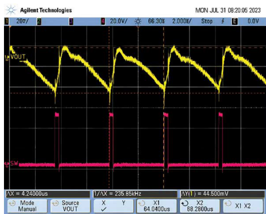
图7. 稳定的输出纹波。
